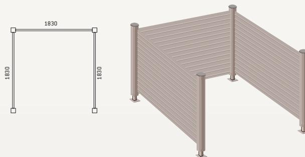
Exemple de configuration possible : 6 poteaux + 2 bardages L 900 mm + 3 bardages L 1830 mm
